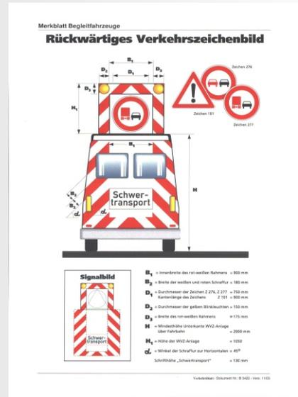
Unsere WVZ-Anlage entspricht in allen Anforderungen dem "Merkblatt für die Ausrüstung der privaten, firmeneigenen Begleitfahrzeuge für Großraum- und Schwertransporte 1992", ist von der Bundesanstalt für Straßenwesen BaSt geprüft mit Prüf-Nr. V4-115-03-BF3 (ersetzt unsere ersten BaSt-Prüfungen aus den Jahren 1999 Nr. V6-0799-BF3 und 2003 Nr. V4-8503-BF3) und hat die BaSt.-Freigabe.
